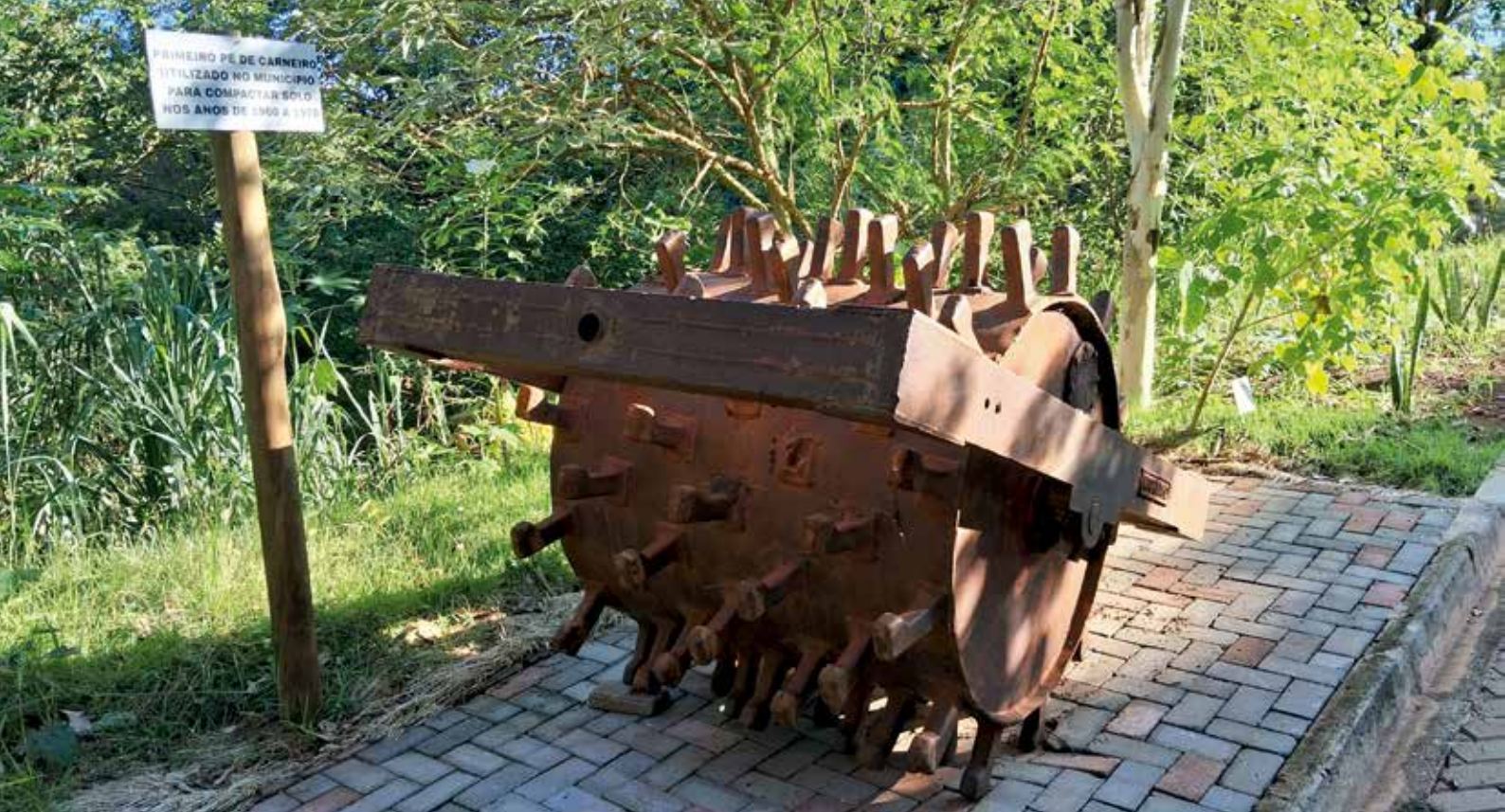
Completando o trio de relíquias, o "Pé de Carneiro", também em ferro, utilizado para compactar o solo nos anos de 1960 a 1970, evoca a memória dos tempos em que trabalho manual era essencial para a construção de estradas e outras obras públicas. Essa peça robusta representa a garra e a dedicação do povo de Nova Esperança
